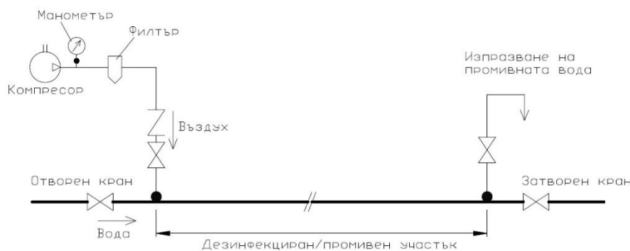
Фиг. 3. Инсталация за хидропневматично промиване
